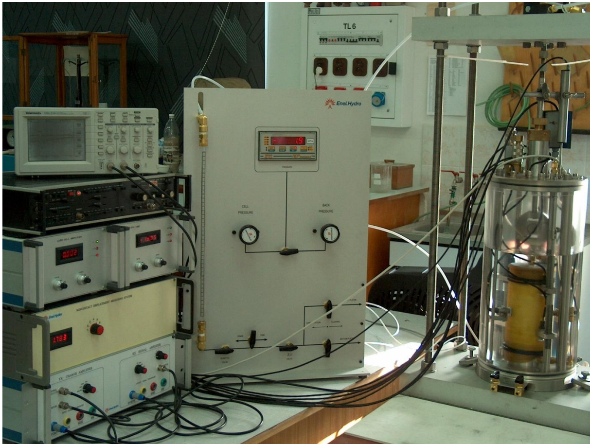
Rys. 3.2. System do badań trójosiowych firmy Enel-Hydro (fot. IBW PAN).
