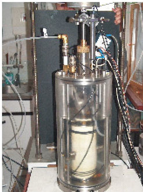
Fig. 9. Aparat trójosiowego ściskania do badania gruntu poddanego obciążeniom cyklicznym (fot. W. Świdziński)
