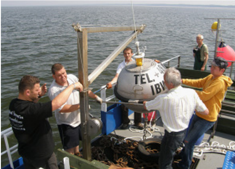
Fig. 11. Stawianie boi wave rider w miejscu pomiarowym na Bałtyku (fot. D. Piotrowska)
