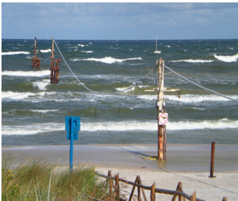
Fig. 6. Dalby pomiarowe w Morskim Laboratorium Brzegowym w Lubiawie. Zdjęcie ma wartość historyczną, gdyż dalby zostały zniszczone przez morze. Na początku było aż 7 dalb (fot. D. Piotrowska)
