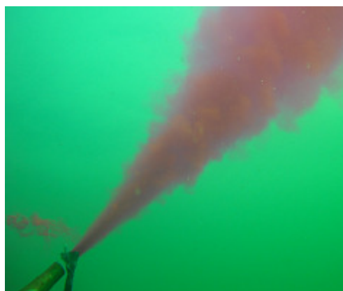
Fig. 16. Struga solanki wyrzucana z dyszy dyfuzora (fot. Investgas S.A.)
